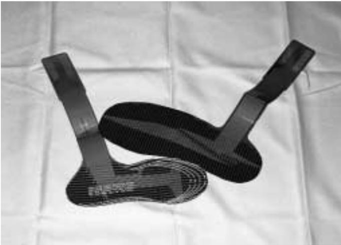
**Abb. 3** Zuschneidbare Druckmesseinlagen des F-scan-Systems.
